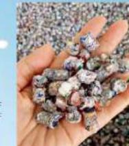
RPF 被廣泛應用於各大小工廠，代替煤或天然氣、節約能源、減低成本之餘，採用的再生固體燃料在進行燃燒時更可減少 30% 污染物及二氧化碳，以及每次處理爐灰時減少 80% 雜積份量。
